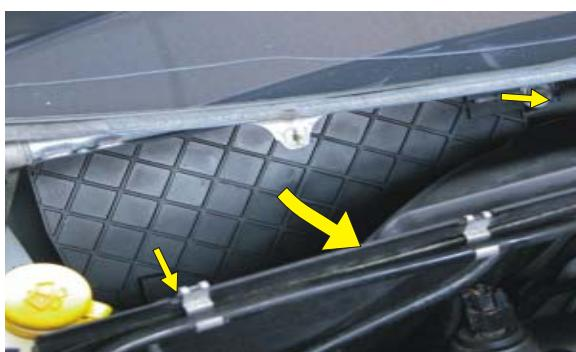
**PL** Odpiąć klipsy zabezpieczające obudowy filtra. Usunąć pokrywę filtra
